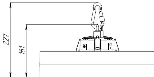
Рисунок 1. Светильник Wheel с подвесным креплением
